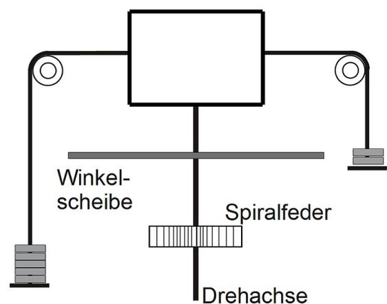
Abbildung 2: Anordnung zur statischen Bestimmung der Winkelrichtgröße.
