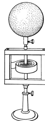
Abbildung 1: Senkrecht stehende Drehachse mit Kugel als Probekörper. Aus Pohl, Physik, Band 1, Springer-Verlag, von R. W. Pohl als „Drillachse“ bezeichnet. Ein Ende der Spiralfeder ist am Stativ, das andere an der Achse befestigt.
